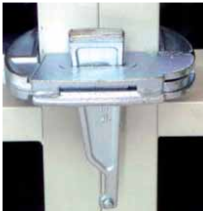
Fot. 3. Do łączenia ram używane są tylko dwa zamki
